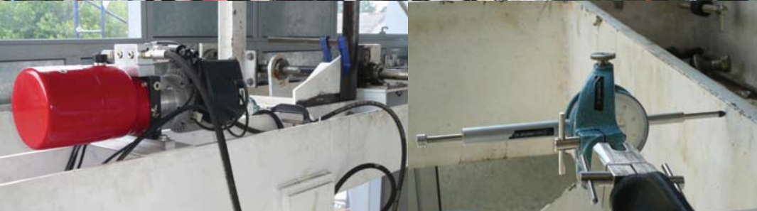
Arriba, prueba de resistencia al viento y evaluación de filtraciones de agua. Abajo, sensores sísmicos y de evaluación al comportamiento frente a las pruebas de viento y agua.
